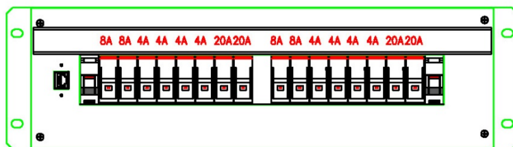
PDU MULTIUTENTE 48Vcc POTENZA 4kW 83A CON 2 UTENTI DA 300W/4 UTENTI DA 150W/2 UTENTI DA 800W
