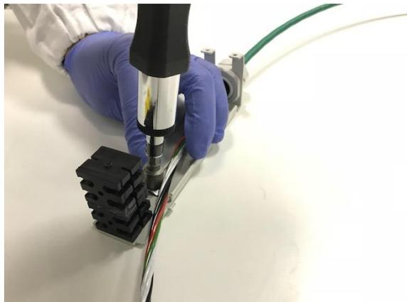
Inserire l'elemento di tiro del cavo nell'apposito elemento di blocco.
